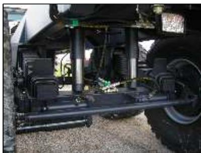
**Anti-cabrage**, sur simple effet tracteur ou automatique couplé au bennage pour un bennage sécurisé.
