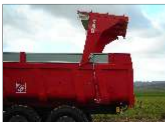
Porte hydraulique pour les bennages de produits collants (fumier, ensilage...)
