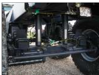
Anti-cabrage , sur simple effet tracteur ou automatique couplé au bannage pour un bannage sécurisé.
