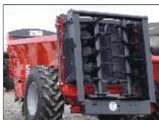
Hérissons verticaux Diamètre : 860 mm
