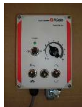
Boîtier de commande de la centrale hydraulique
