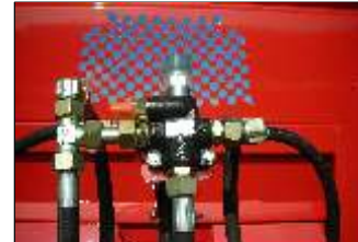
Réglage de la vitesse du tapis sur la potence
