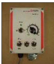
Boîtier de commande de la centrale hydraulique
