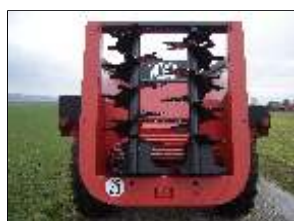
Hérissons verticaux Diamètre : 670 mm ou 730 mm
