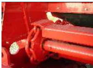
Tapis composé de 2 chaînes marine de 12 x 42 ou 14 x 49
