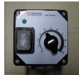
Boîtier électronique pour régler la vitesse du tapis
