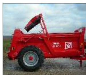
Porte hydraulique articulée
