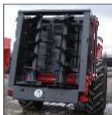
Hérissons verticaux Diamètre : 860 mm
