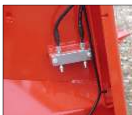
Graissage déporté des paliers des hérissons
