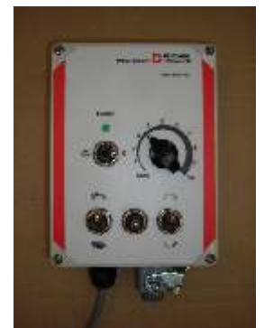
Boîtier de commande de la centrale hydraulique
