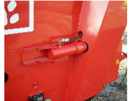
Tension hydraulique du tapis
