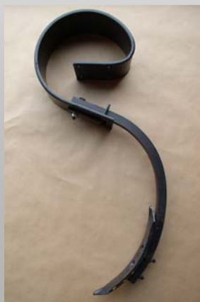
Dent « Flex » avec lame supérieure 150 x 10 mm
