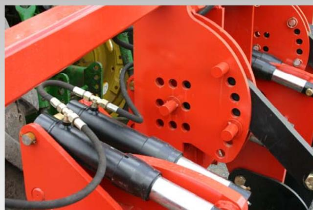
L'outil est équipé en option d'un relevage arrière afin de pouvoir atteler un outil animé et un semoir. Le réglage de hauteur d'attelage se réalise par l'intermédiaire de broches (pour les butées hautes et basses) et d'un secteur à trous.
