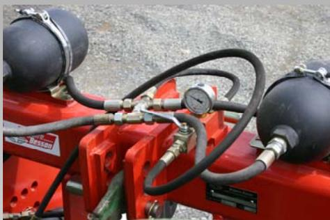
Le circuit hydraulique est monté en série avec 2 accumulateurs de grande capacité qui assurent le déclenchement de plusieurs éléments en même temps sans endommager la machine.
