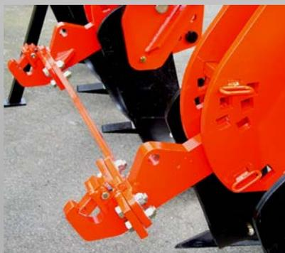
Il est possible d'équiper l'outil en option d'un relevage arrière flottant à accrochage semi-automatique. Le réglage de hauteur d'attelage se réalise par des broches (pour les butées hautes et basses).
