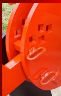
Les broches de réglage de hauteur d'attelage sont de forme carré pour une meilleure résistance et un meilleur appui.
