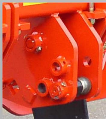
L'outil est équipé de série d'un attelage catégorie III. Il est possible de régler l'attelage avec précision avec 2 hauteurs et 2 réglages de profondeurs: Ce système spécifique permet notamment d'optimiser du porte à faux de 560 ou 500 mm suivant l'attelage.
