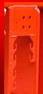
Support pour le passage de rallonges hydrauliques ou électriques intégrées dans le châssis.
