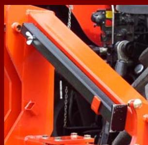
Béquille de support avec rangement intégré au châssis.
