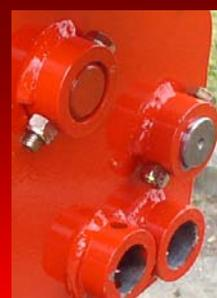
L'ensemble des axes sont bloqués en rotation pour une meilleure résistance à l'usure.
