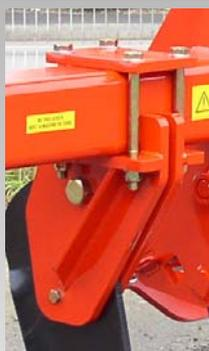
En conditions difficiles, il est conseillé d'équiper le boîtier de dent en option d'un système de fixation par contre-plaque.
