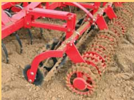
Combinaison d'un rouleau cranté et croskillettes.
