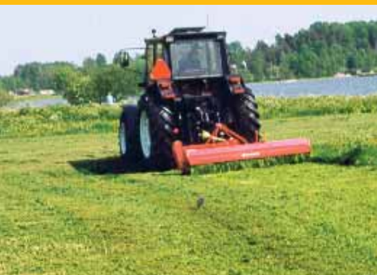
Le broyeur Kverneland FH peut recevoir un rateau à dents pour améliorer le broyage des sarments.
