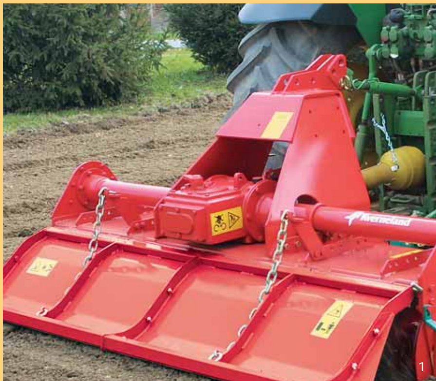
1. Boîte à levier 3 vitesses Le changement de régime de rotation du rotor se fait d'un simple geste.
