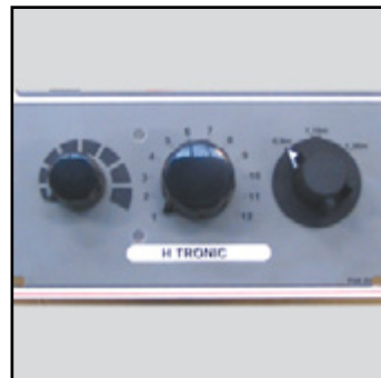
Contrôle de hauteur de rampe H-Tronic
