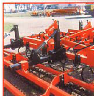
Réglage en hauteur des rouleaux arrières par vis avec amortisseur sur ressort. Height adjustment with screw and shock absorber spring. Höbeverstellung mit Schrauben und Federstossfänger.
