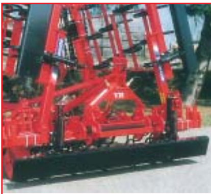
Le vibrocoltueur de type VR GC est équipé d'un attelage en chape de série With serial automatic coupling Mit Serien Schnellkupplung
