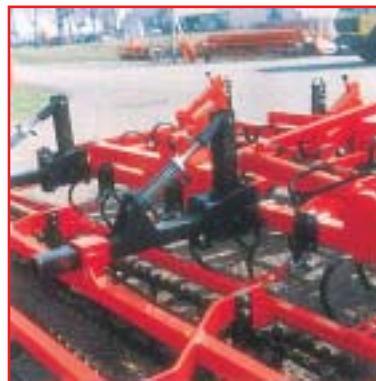
Réglage en hauteur des rouleaux arrière par vis avec amortisseur sur ressort Height adjustment with screw and shock absorber spring Höbeverstellung mit Schrauben und Federdämpfer
