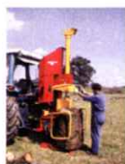
Fendeuses de bûches et pieux
